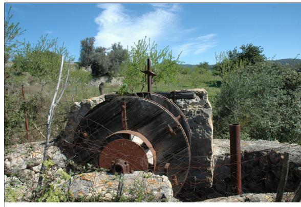
Descripción: Vista del Muro de la sinia, pozo, columnas y rueda horizontal.
